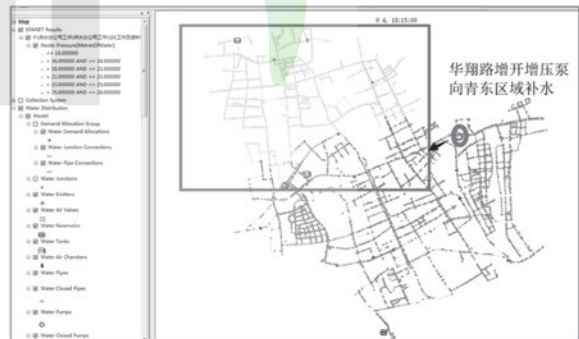
图 11 徐泾水厂 DN1000 管停用，应急响应措施
