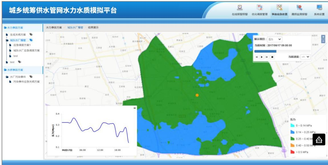
图 4-6 关阀后的水泵调度方案压力结果
