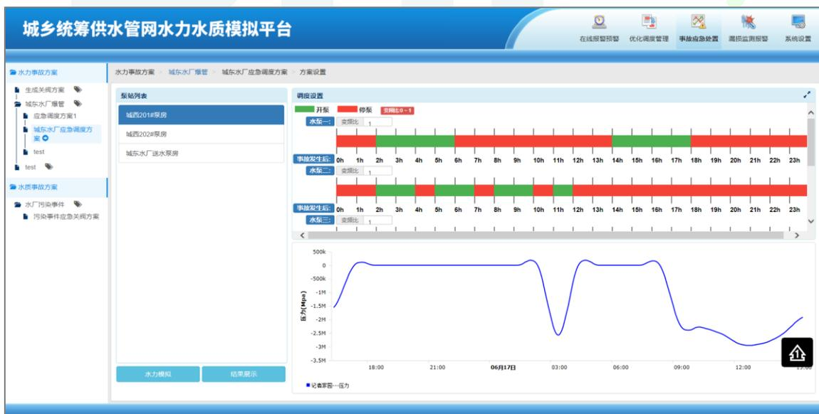
图 4-5 关阀后的水泵调度方案设置
