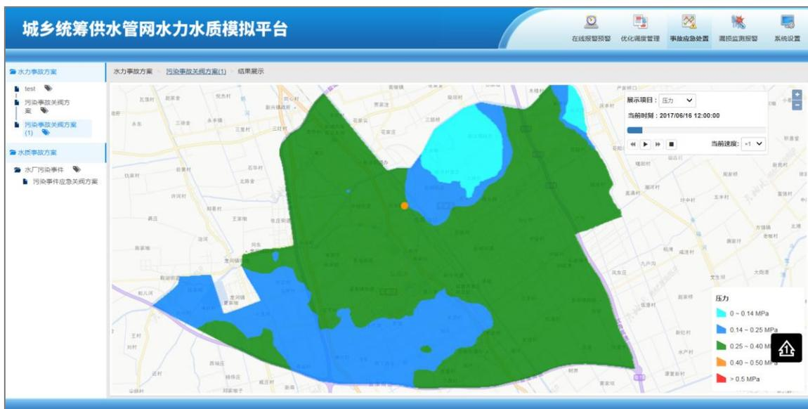
图 4-4 关阀后模拟供水压力分布
