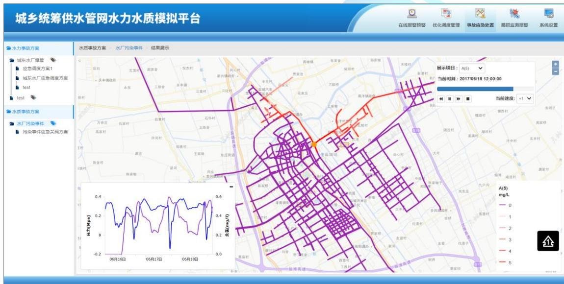
图 4-2 在系统中模拟污染物随时间的扩散过程
